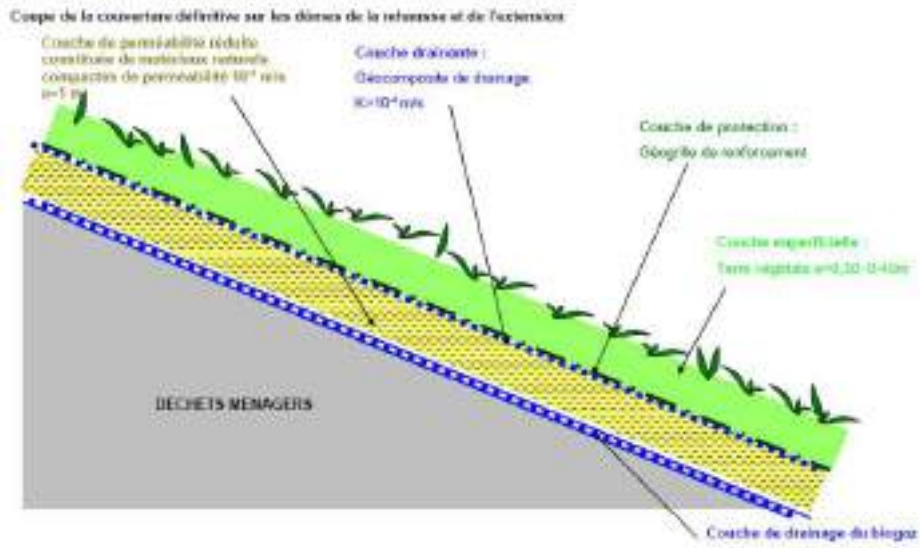
Schéma de principe de la couverture W3-W4
